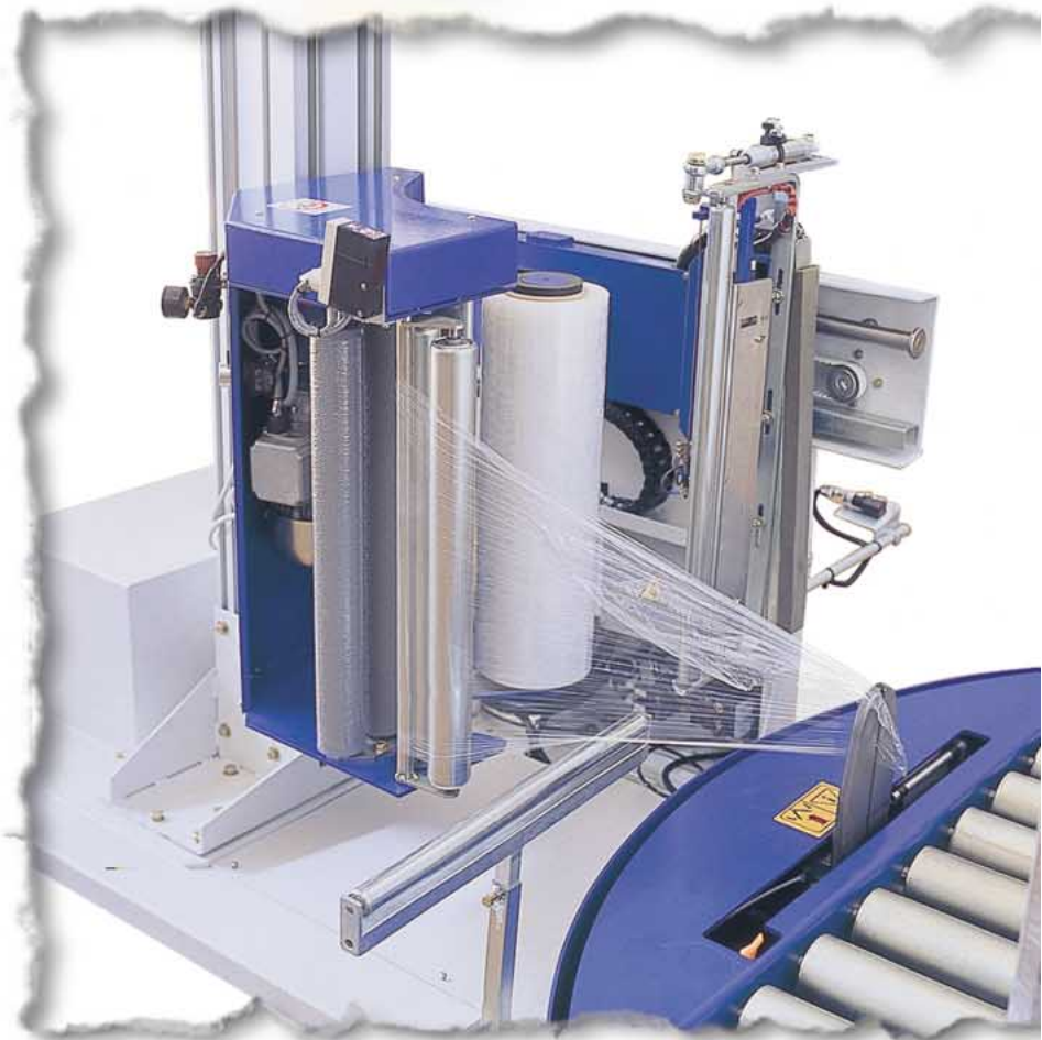
Mettifoglio automatico Automatic sheet insertion device
